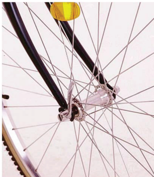
Figure 7 Mauvaise position du mécanisme de démontage rapide, deuxième exemple
